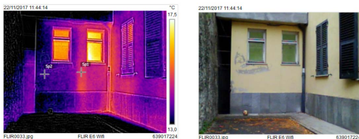
Figura 4.5 –Rilievo termografico dei serramenti - esempio
